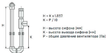
Отвод конденсата (рис. 5)
