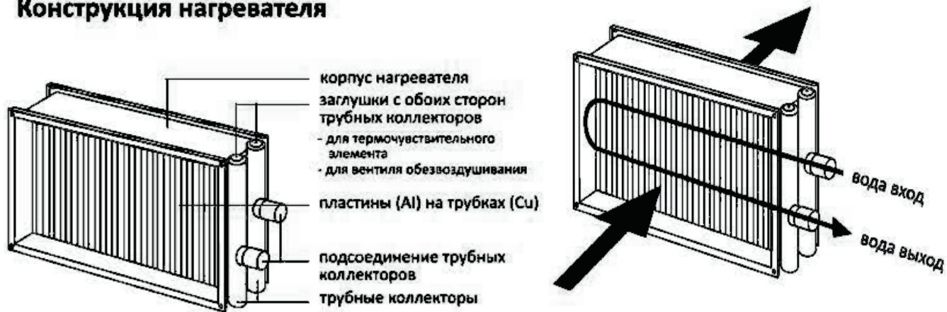
Рисунок 16. Конструкция водяного нагревателя
